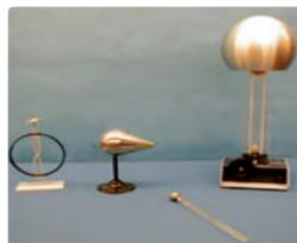
شکل ۱-۳۳۳: انحراف آزمایش چگونگی توزیع بار روی سطح خارجی یک جسم رسانای باردار
