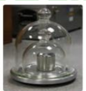
شکل ۱-۷ استاندارد ملی کیلوگرم که نسخه دقیقی از استاندارد بین المللی سور فرانسه است . این نمونه ، در مرکز اندازه شناسی در سازمان ملی استاندارد ایران نگهداری می شود.
